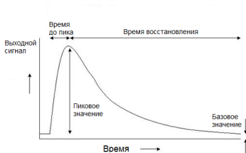
Рисунок 3. Форма изменения сигнала электрохимического датчика
